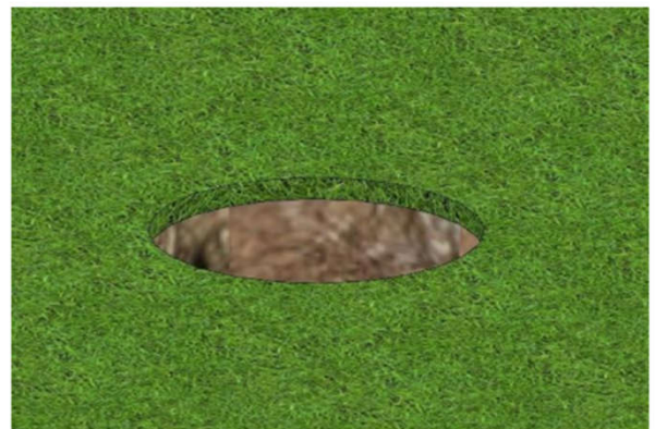
Loch in den Boden graben (Dosenhöhe) Lochdurchmesser = Dosedurchmesser + 80mm
